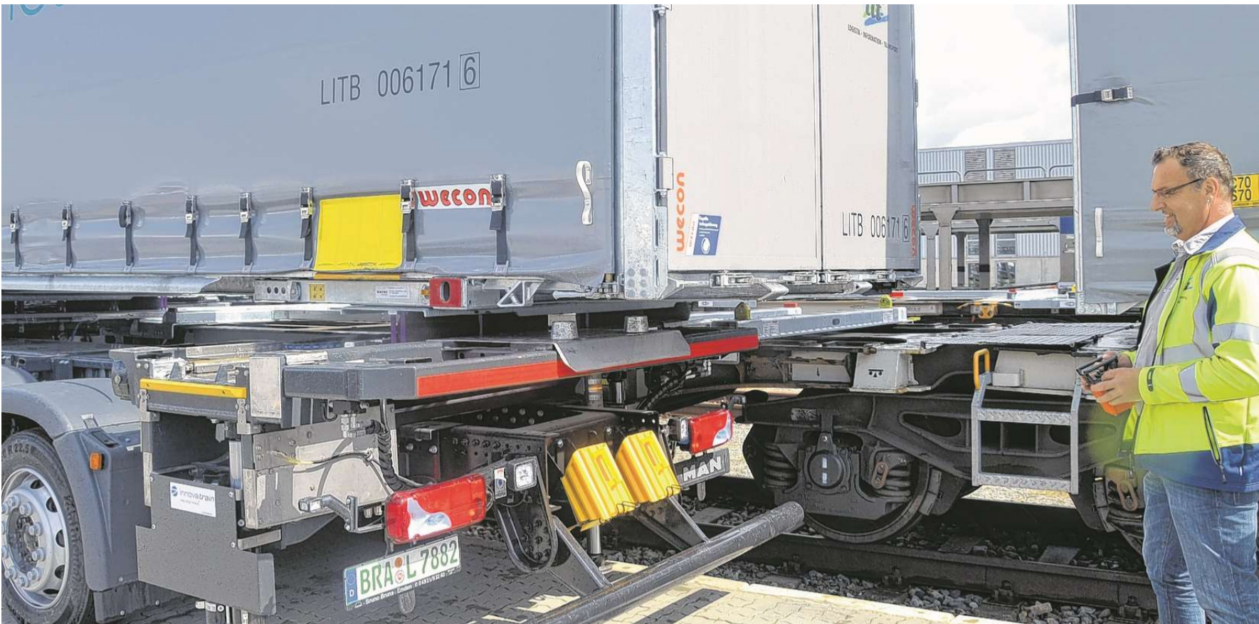
Ein Mitarbeiter der Firma L.I.T. verschiebt per Joystick einen Container vom Bahnwaggon auf einen Lkw.
