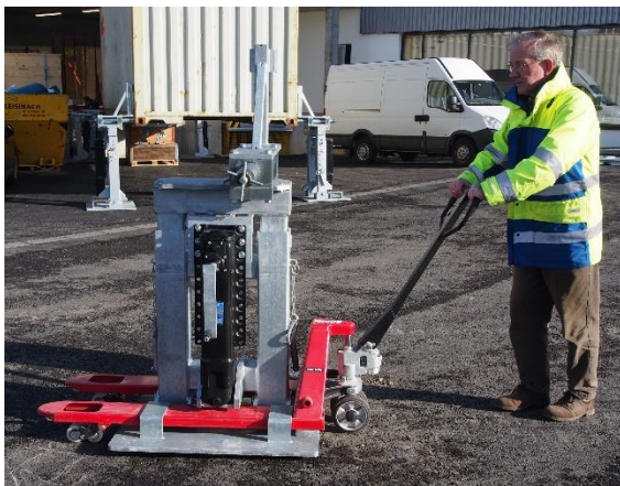
Positionierbare Stützen mit Palettenhubwagen verschiebbar
