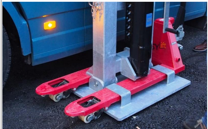
Positionierbare Stützen mit Palettenhubwagen verschiebbar
