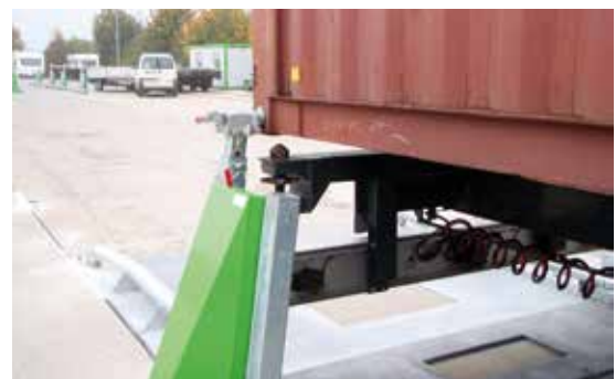
Die Stützen nehmen den Container über die ISO-Eckbeschläge auf
