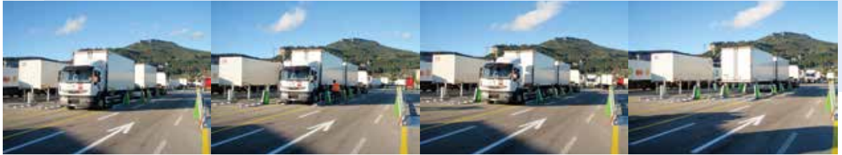
Einfahren und positionieren ... Stützen anlegen ... Chassis absenken ... Ausfahren
